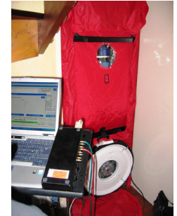
essai Blower Door
